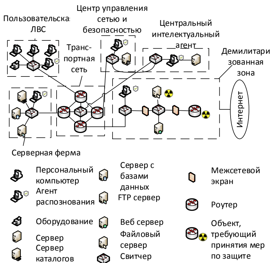
Рис. 1. Структурная схема ИВС с агентами распознавания вторжений
