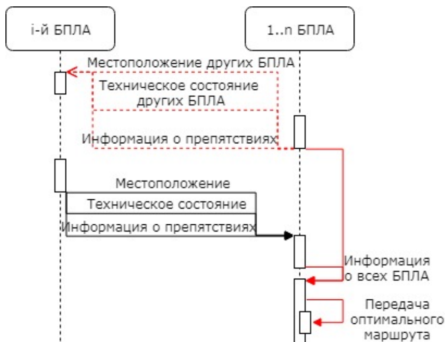
Рис. 1. Уязвимые информационные сообщения и процессы в обобщенной модели ИВ элементов группы БПЛА
