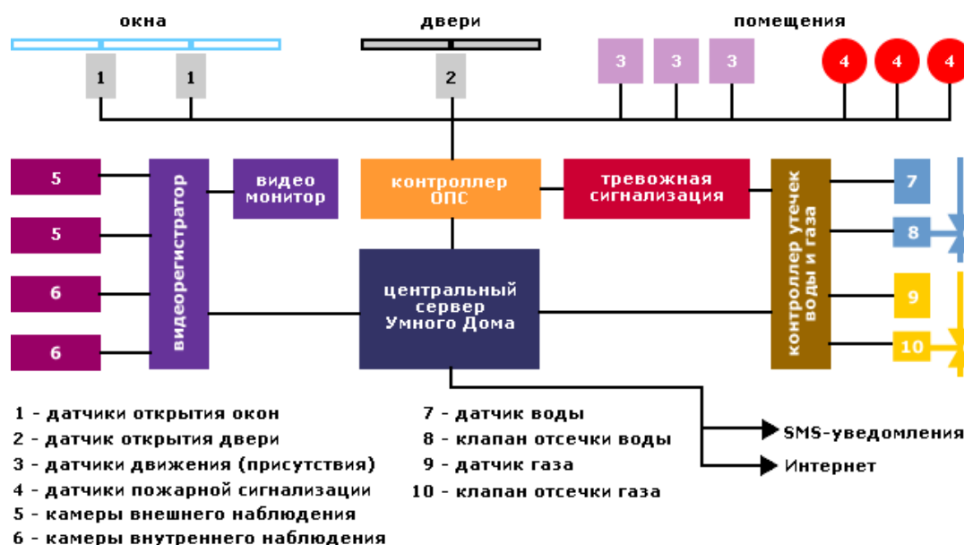
Рис. 4. Контроль всех систем в доме
