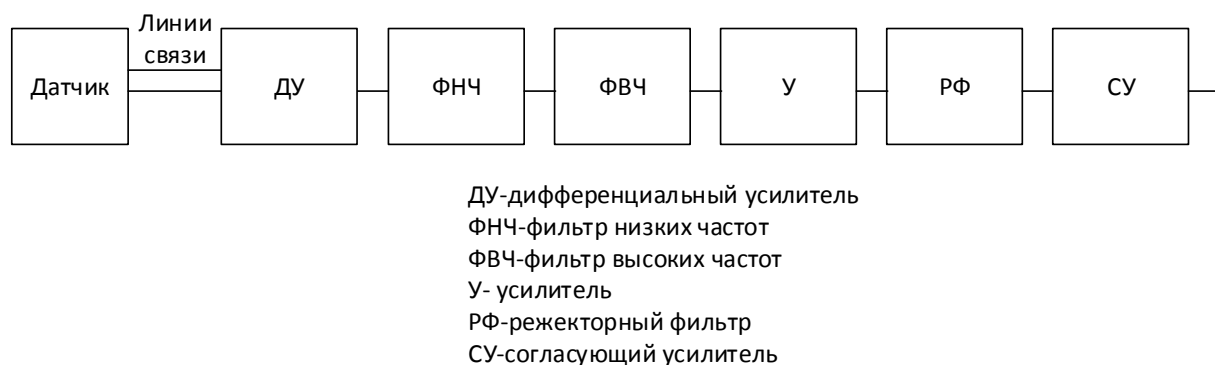
Рис. 1. Структурная схема ТПОС
