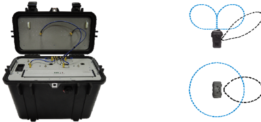
Рис. 2. Внешний вид и диаграммы направленности антенн СП «Купол»
