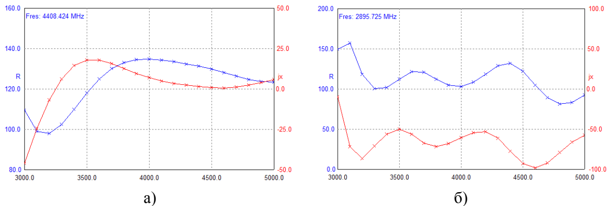
Рис. 3. Сравнение импедансов двухзаходной (а) и однозаходной (б) спиральных антенн
