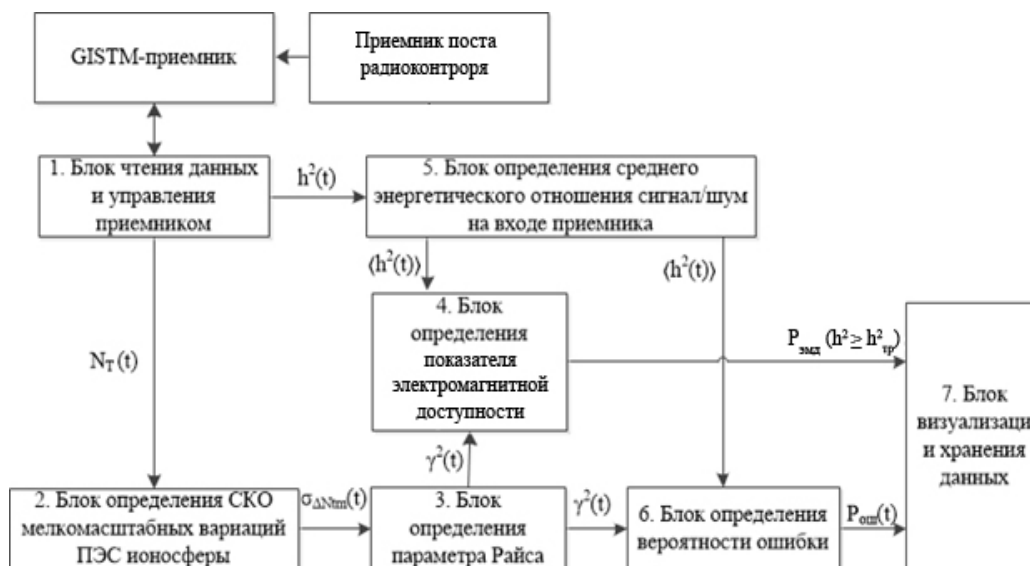
Рис. 1. Общая структурная схема комплекса прогнозирования значений ошибочного приема информационных символов систем радиоконтроля с пониженной несущей частотой
