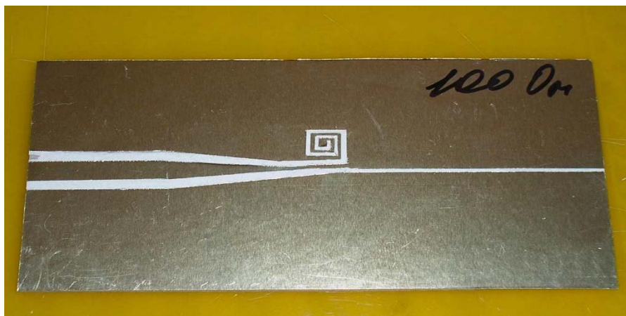
Рис. 10. Масштабный макет копланарно-щелевого перехода (подложка – пенополистерол, проводник – латунная фольга)
