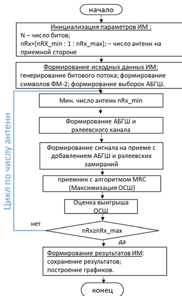
Рис. 1. Алгоритм расчета ОСШ для технологий MIMO и massive MIMO в среде Matlab
