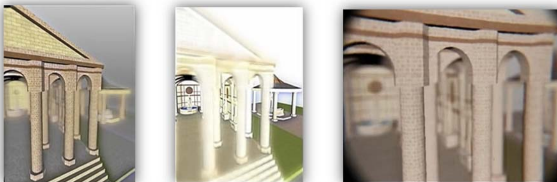
Рис. 2. Пример изображения полученного с помощью технологии NE-LF. Слева на право: изображение на фронтальном дисплее, изображение на тыльном дисплее, финальное изображение с фокусом на переднем плане
