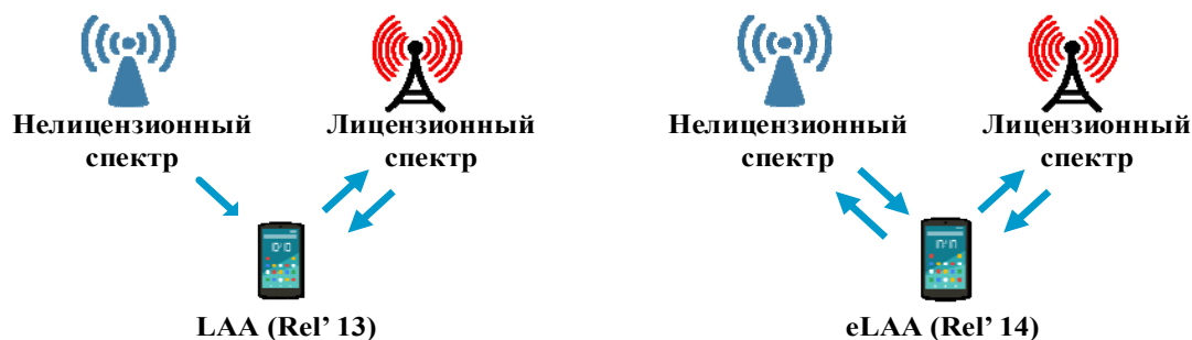
Рис. 2. Принцип работы технологии LAA
