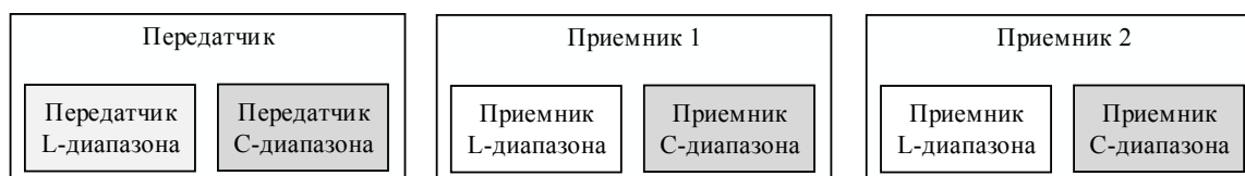
Рис. 2. Структура двухдиапазонного приемопередатчика для измерений [1]
