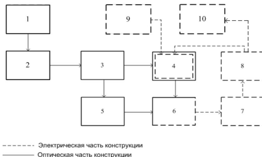
Рис. 1. Структурная схема магнитной антенны, здесь: 1 – модулятора оптического излучения (на частоте 1 МГц); 2 – лазера; блока пространственного разделения оптического луча; 4 – приемной антенны (катушка с кабелем, изображенным на рис. 1); 5 – оптического волокна, изолированного от воздействия электромагнитного поля; 6 – фотодиода; 7 – резонансного усилителя на частоте 1 МГц; 8 – детектор и резонансный усилитель на частоте 50–300 кГц; 9 – источник тока смещения рабочей точки; 10 – индикатора принимаемого сигнала
