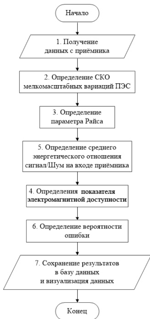
Рис. 2. Алгоритм работы комплекса прогнозирования значений ошибочного приема информационных сигналов системы радиоконтроля с пониженной несущей частотой
