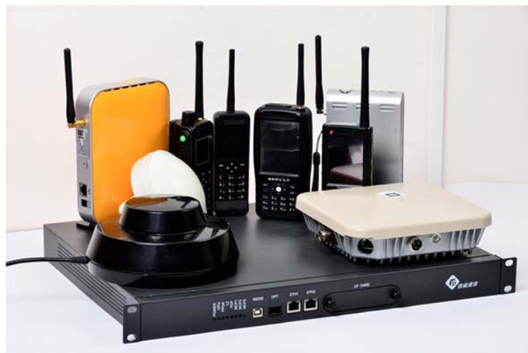
Рис. 3. Оборудование сети широкополосного радиодоступа
