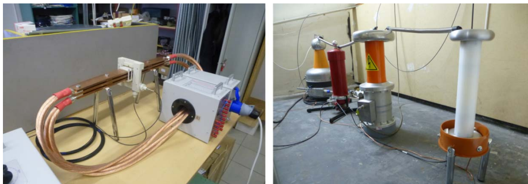
Рис. 5. Внешний вид магнитооптического измерительного преобразователя тока на шине с током (слева) и электрооптического измерительного преобразователя напряжения (справа)
