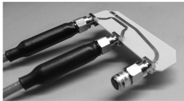
Рис. 6. Экспериментальный образец зубчатого микрополоскового НО, C = 20 дБ, f = (2,5 \div 2,7 ГГц)
