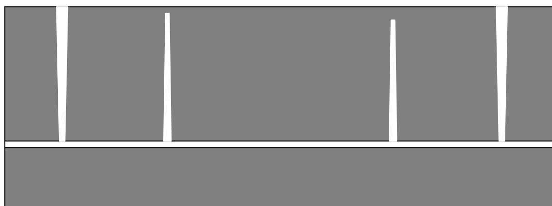
Рис. 3. Общий вид топологии эллиптического полосового фильтра – прототипа 3 порядка, при реализации на щелевых линиях
