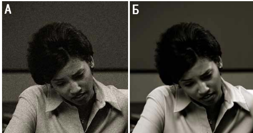
Рис. 1. Измерение среднего квадрата ошибки ( MSE ) для этих двух сжатых изображений показывает, что А искажено сильнее, чем Б, но Б выглядит лучше
