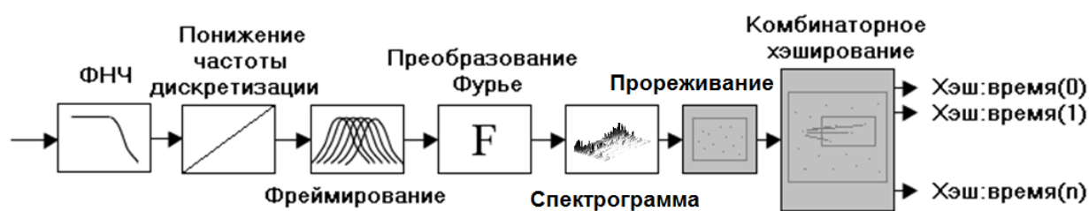
Рис. 2. Функциональная схема метода получения звукового отпечатка алгоритма Shazam
