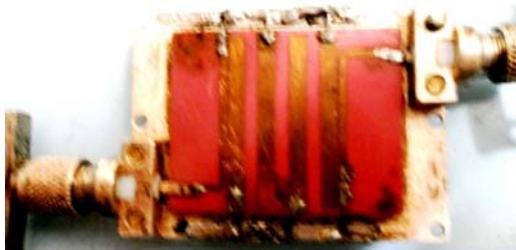
Рис. 1. Лабораторный макет микрополоскового фильтра 6-го порядка на встречных стержнях
