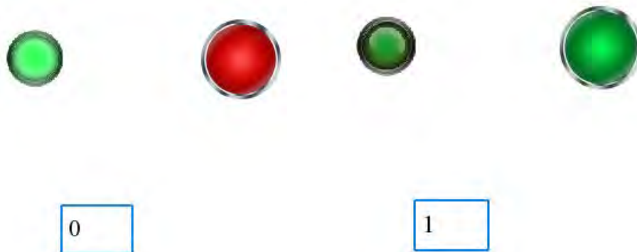
Рис. 2. Представление сигнала в случае его принадлежности к типу «boolean»
