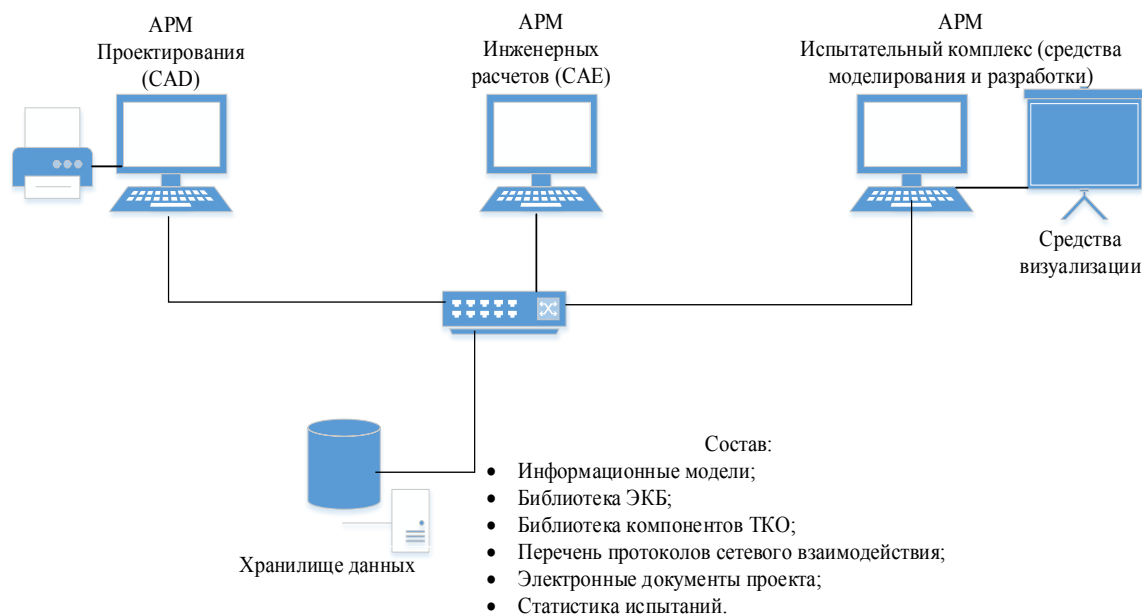
Рис. 1. Вариант структуры ЦД ТКО и испытательного комплекса
