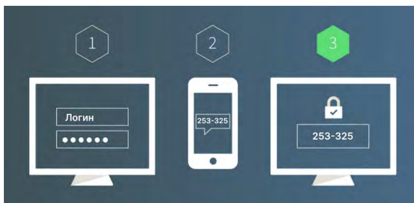
Рис. 1. Процесс двухфакторной аутентификации посредством SMS-кода
