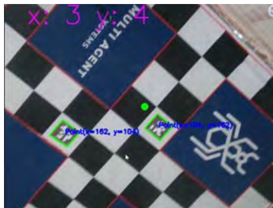
Рис. 4. Пример работы алгоритма, при нахождении стереокамеры над клеткой (3, 4) и поворотом 135 градусов
