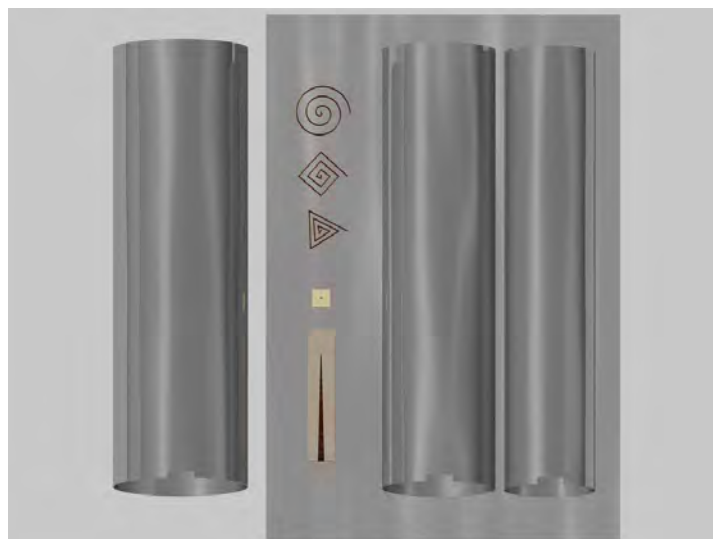
Рис. 6. 3D модель сборочного комплекса макетов с различными диаметрами волноводов 150, 125, 100 мм
