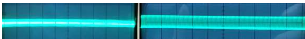
Рис. 4. Сигнал помехи с включенной цепью ОС (слева) и с выключенной цепью ОС (справа). Масштаб на экране осциллографа одинаковый
