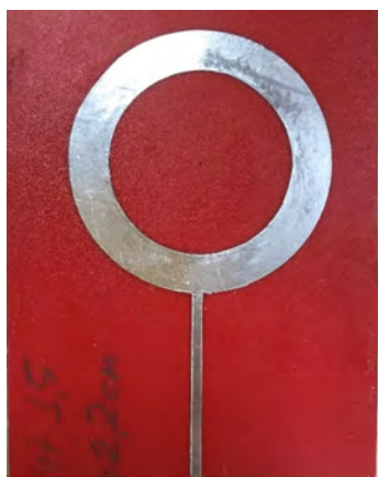
Рис. 8. Кольцевой резонатор в качестве излучателя с подложкой из пенополиуретана
