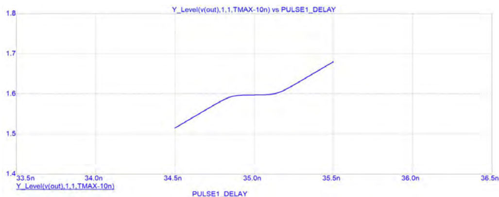
Рис. 6. Зона нелинейности при задержке сброса триггеров 0,01 нс
