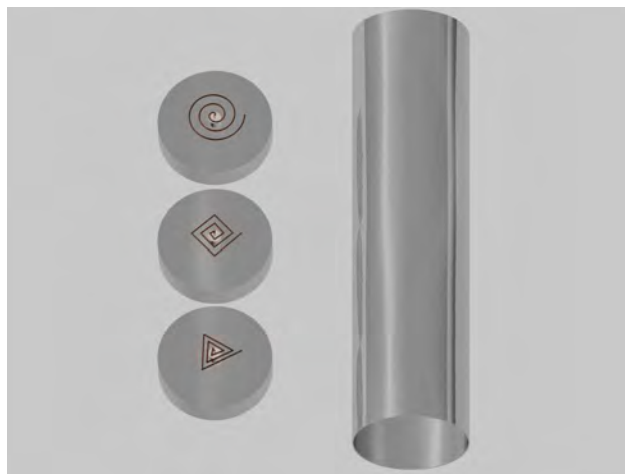
Рис. 4. 3D модель сборочного комплекса макетов с диаметром волновода 125 мм
