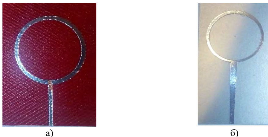
Рис. 5. Излучатель на основе кольцевого резонатора с использованием подложки: а) из гофрированного полистирола, б) из технического пенополилена
