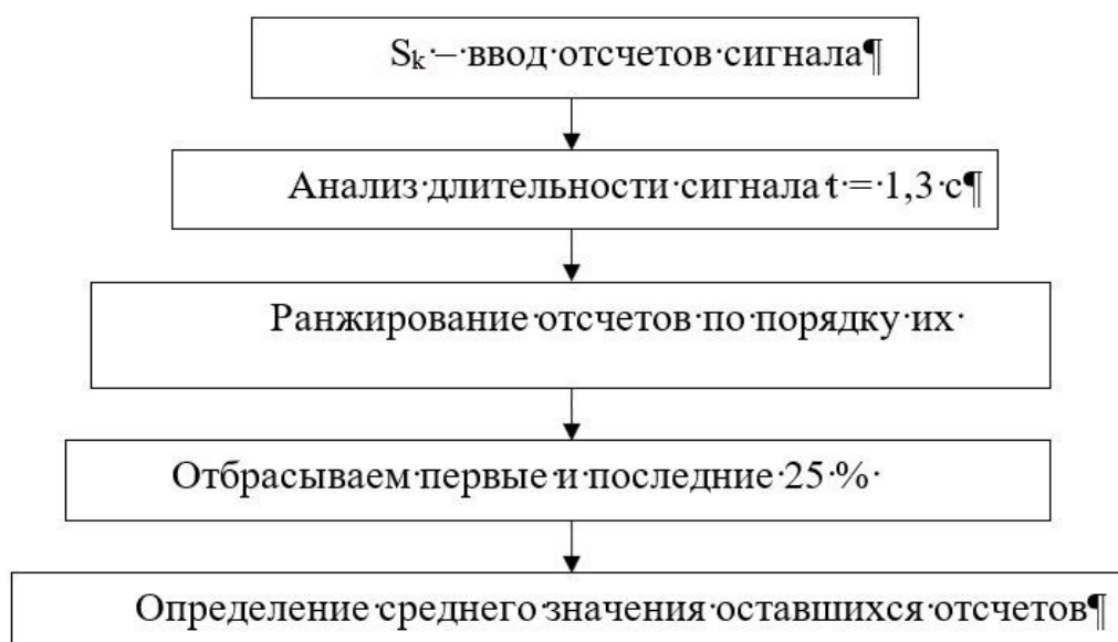
Рис. 1. Блок-схема алгоритма устранения дрейфа изолинии
