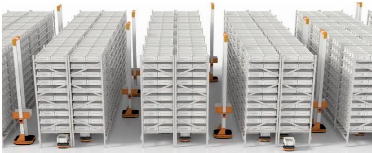
Рис. 3. Модель хранения товара на автоматизированном складе с использованием двух типов роботов
