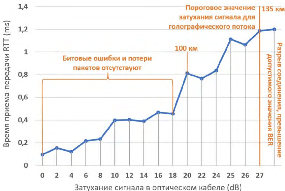
Рис. 2. Воздействие затухания сигнала на величины RTT и BER
