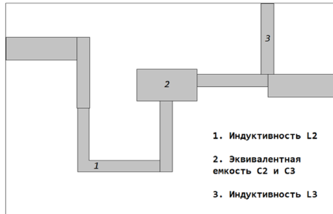
Рис. 3. Полученная топология ГИС на подложке размером 30×48 мм
