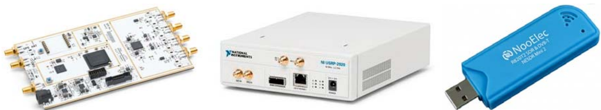
Рис. 1. Отладочные платы ПКР (слева направо: Ettus B210, NI USRP-2932 и RTL-SDR)
