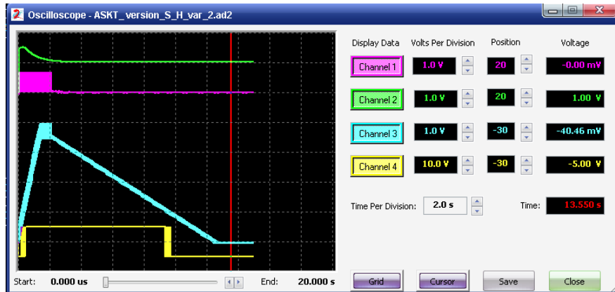
Рис. 5. Зависимости на выходе различных блоков тракта обработки сигнала: зеленый – выход ФНЧ; красный – выход УД; синий – выход Н; желтый – выход ПУ
