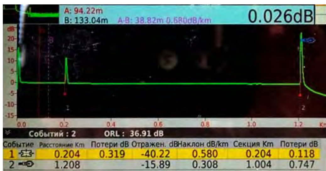
Рис. 2. Рефлектограмма, полученная в пятом испытании после сварки
