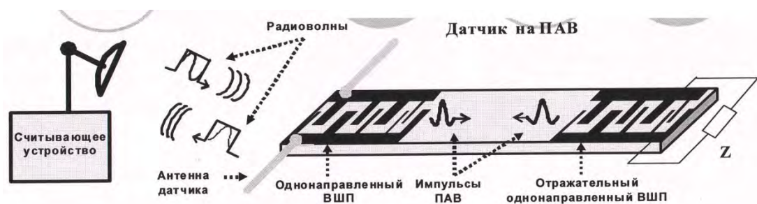
Рис. 2. Пассивный ПАВ-датчик физической величины с внешней чувствительной нагрузкой
