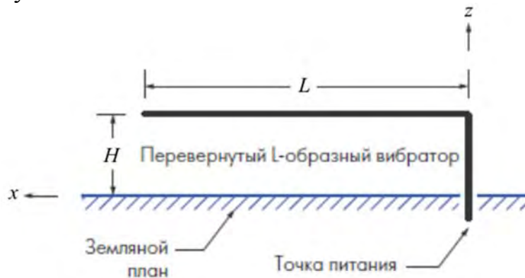
Рис. 1. Перевернутый L-образный вибратор
