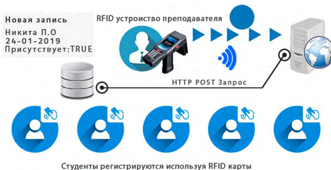
Рис. 2. Сценарий учета посещаемости с использованием RFID устройства
