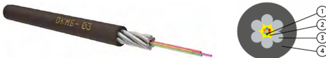
Рис. 2. Конструкция кабеля ОКМБ-03: 1 – волоконный световод, 2 – гидрофобный наполнитель, 3 – броня из тонкой оцинкованной проволоки, 4 – защитное полимерное покрытие
