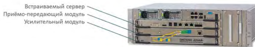
Рис. 4. Внешний вид и описание блоков оборудования «Дунай»
