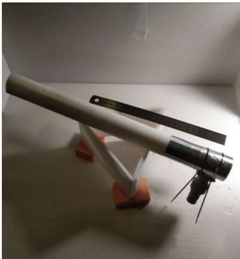
Рис. 4. Синтезированный масштабный макет с увеличенным рефлектором
