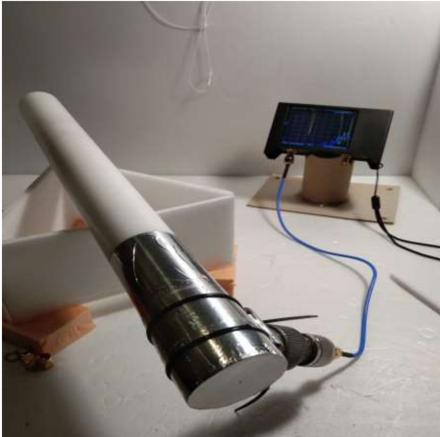
Рис. 5. Измерительный стенд синтезированного макета диэлектрической антенны
