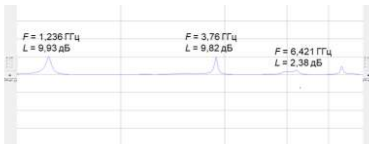
Рис. 9. Эмуляция генератора с шириной полоска w = 2,25 мм и Z_B = 50,4 Ом
