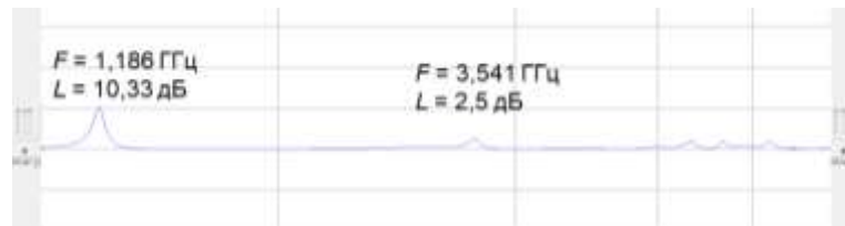
Рис. 7. Эмуляция генератора с шириной полоска w = 1,45 мм и Z_B = 65,6 Ом
